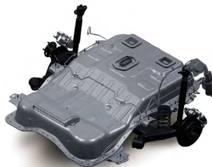
Batterie de 28 kWh montrée
