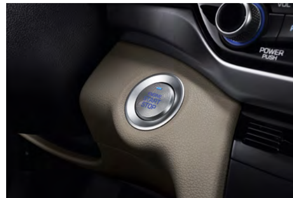
Clé à capteur de proximité avec démarrage à bouton-poussoir livrable
