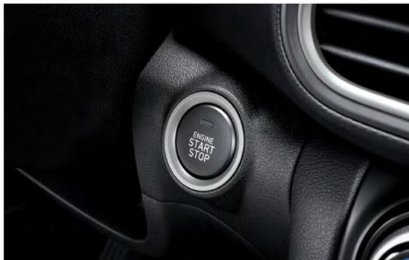
Clé à capteur de proximité livrable avec démarrage à bouton poussoir
