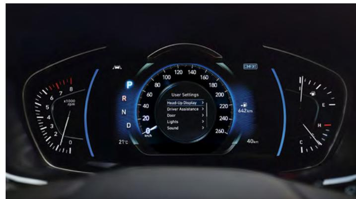
Instrumentation électroluminescente livrable avec écran de supervision ACL de 7 po et ordinateur de bord
