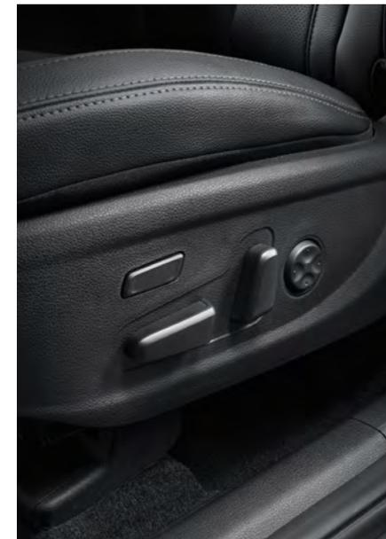
Siège du conducteur à réglage électrique en 12 directions livrable avec rallonge électrique pour les cuisses
