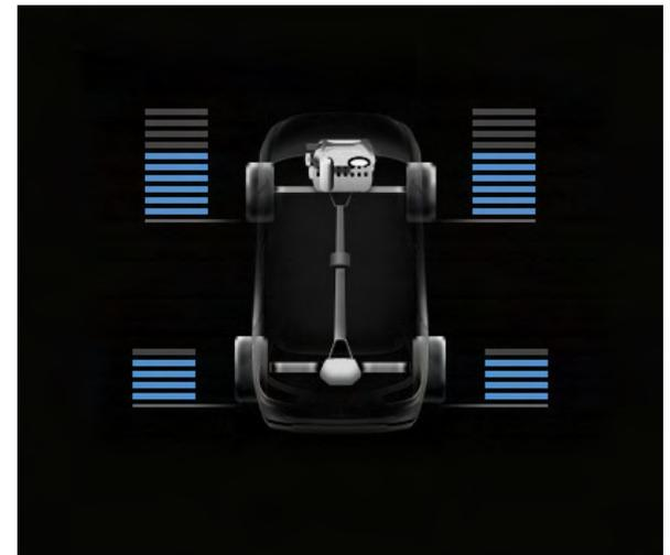
**MODE << SPORT >>** : Contrôle dynamique. Transmet jusqu'à 50 pour cent du couple aux roues arrière, pour une plus grande agilité.
