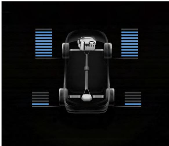
**MODE << SMART >>** : Mode à privilégier pour l'économie de carburant. Rehausse l'efficacité en transmettant la puissance principalement aux roues avant.
