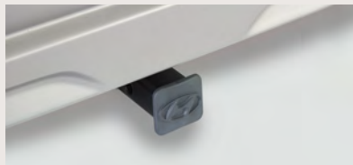
Attelage d'accessoires Cet attelage d'accessoires permet d'installer rapidement et facilement un support d'attelage, tel qu'un porte-vélo ou un porte-skis. Non conçu pour le remorquage.
