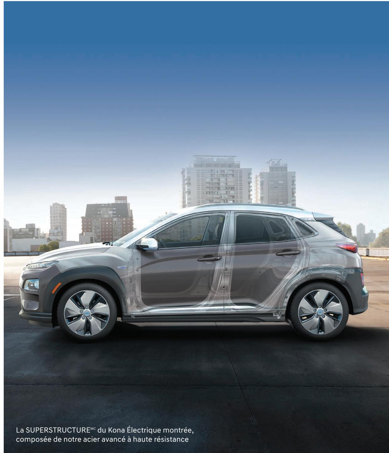
La SUPERSTRUCTURE<sup>MC</sup> du Kona Électrique montrée, composée de notre acier avancé à haute résistance
