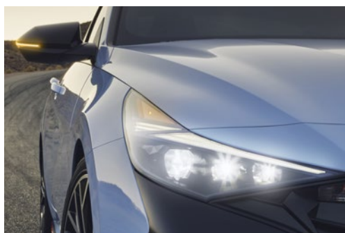
Phares à DEL de type projecteur Phares de jour à DEL Clignotants à DEL intégrés aux rétroviseurs extérieurs
