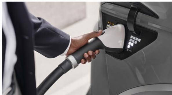
Recharge de la batterie de 10 % à 80 % de sa capacité en 18 minutes seulement grâce à un chargeur ultrarapide de 350 kW à courant continu
