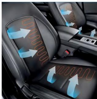
Volant et sièges avant chauffants de série
